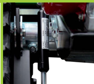
Carro basculante con molla di compensazione a gas Tilting chassis with compensation spring
