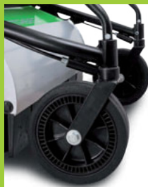
Bloccaggio ruote anteriori rapido con comando a console Front wheels brake easy to use
