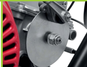
Freno a disco sincronizzato con comando frizione Disc brake synchronized with clutch lever
