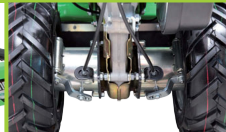
Asse ruote con sbloccaggi indipendenti Wheel axle Independent releases
