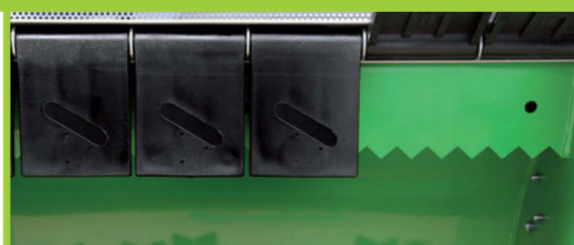
Gruppo di taglio con controcoltello e bandelle oscillanti Cutting unit with oscillating safety protections and bottom blade
