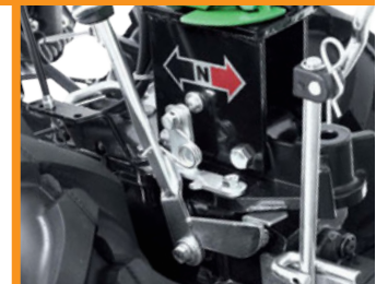
Inversore rapido Quick inverter
