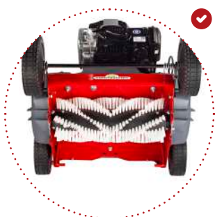
Spazzola elicoidale in nylon, larghezza 36 cm velocità di rotazione 2.600 rpm
